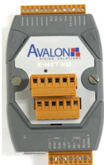
Le grand connecteur orange est utilisé pour les entrées de presse (i.e. Mold Open, Ejectors Back, Safety Gate Closed et Cores Pulled) énumérées dans le tableau des entrées ci-dessous. La tour d'alarme sera connectée au connecteur orange supérieur comme indiqué dans le tableau des sorties à la page suivante.
