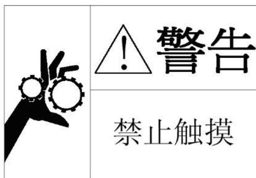
Si la plage de fonctionnement est utilisée pour des raisons de maintenance ou pour d'autres raisons, ne pas toucher le moteur, ni l'axe de rotation, ni la courroie car il y a un risque d'enroulement dans la machine.
