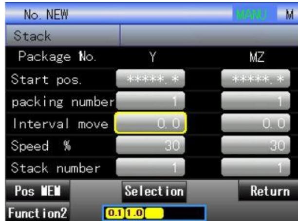
Sur cet écran, il est possible de définir l'espacement des produits. Par exemple, lorsque la valeur de réglage est 10.0, les produits sont libérés à une distance de 10 mm, la méthode de saisie de la valeur numérique étant identique à celle utilisée dans le réglage de la « position de départ ».
