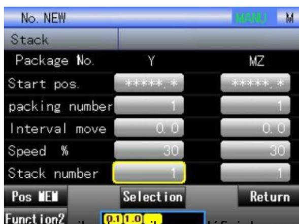
Sur l'écran de numéro de pile, il est possible de définir le numéro de la position d'axe, avec une plage réglable entre 1 et 127 et un nombre maximal de piles de 127. La méthode de saisie numérique est identique à celle utilisée dans le réglage de la « position de départ ». Le numéro de pile est exactement le nombre maximal de piles souhaité par l'utilisateur ; lorsque le point de départ de la pile et le numéro de pile sont cumulés, les valeurs sont de nouveau cumulées dès le départ.
