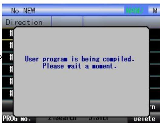
Utiliser la touche « ← » / « → » pour sélectionner « OUI » et appuyer sur la touche « ■ » pour effectuer une transformation de programme. À la fin de l'assemblage du programme, s'il n'y a aucune erreur, revenir à l'écran principal du programme et mettre fin à l'instruction (l'apprentissage).
