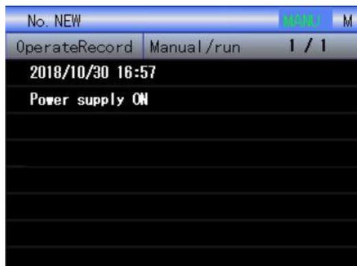
L'écran ci-dessus montre les enregistrements d'opérations/de fonctionnement manuel qui peuvent être utilisés pour confirmer le contenu des opérations et le temps d'exécution. Il est possible d'appuyer sur la touche 「→」 pour changer l'écran et le définir comme ci-dessous.
