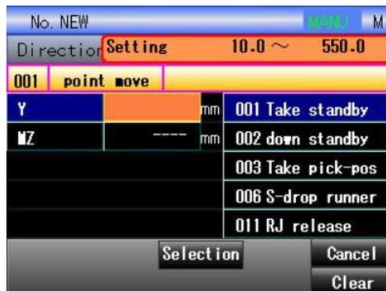
Sur l'écran de sélection d'axe, appuyer sur la touche « ■ » pour renouveler la « sélection/non sélection ». Après la sélection, définir le numéro de série du point. Puis définir la position souhaitée. Utiliser le bouton [→] pour sélectionner la position de la valeur numérique ①, appuyer sur la touche « ■ ». Lorsqu'elle s'affiche en orange, utiliser la touche d'action pour saisir la valeur numérique de déplacement. Après la confirmation de la valeur saisie, appuyer sur la touche « ■ ».
