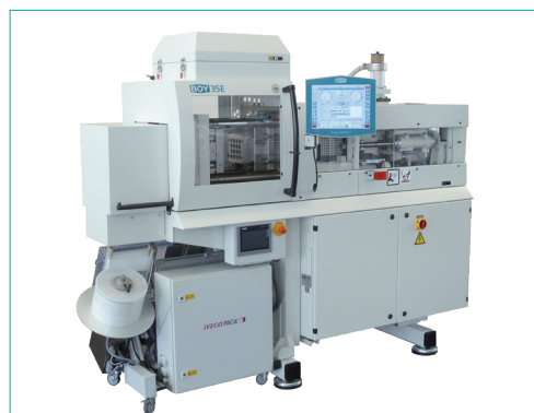
Flux laminaire autonome avec système d'ensachage en ligne, pour la production de pièces «propres».
